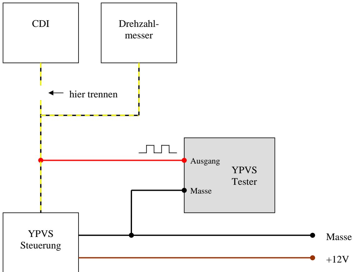
Dabei ist zu beachten, daß bei der Prüfung auch die Zündung eingeschaltet wird, damit die YPVS Steuerung und der Drehzahlmesser mit der 12V Bordspannung versorgt wird.
